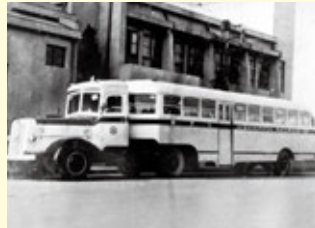
トレーラーバス 戦後復興期の車両不足の中で、車両を改造し大量輸送の使命を担って登場したトレーラーバス。 1948(昭和23)年頃 所蔵:西日本鉄道(株)
